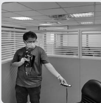
▲ 現場照度檢測。
